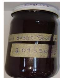
**Composición Merceológica:** Tinta de color azul compuesta por los solventes Propan-1-ol, 1-Propoxi-2-propanol, 1-1-Butoxypropan-2-ol, n-Butilacetato, Etanol y Pigmento azul. Este tipo de tinta a base de solventes orgánicos es utilizado en impresión flexográfica.
