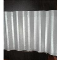
**Composición merceológica:** Lámina metálica ondulada sin alear, galvanizada con un recubrimiento de Aluminio, Zinc. Sin Pintar.
