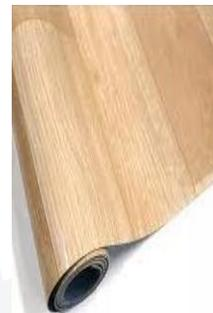
**Composición merceológica:** Lámina Autoadhesiva flexible, elaborada de Cloruro de Polivinilo (PVC) de color beige como imitación de madera, sobre una lámina color negro elaborada por una mezcla de Polietilacrilato, Dioctilftalato (DOP), Carbonato de Calcio, aceite de soya; que además posee el adhesivo acrílico, protegido por una lámina transparente de polietileno.
